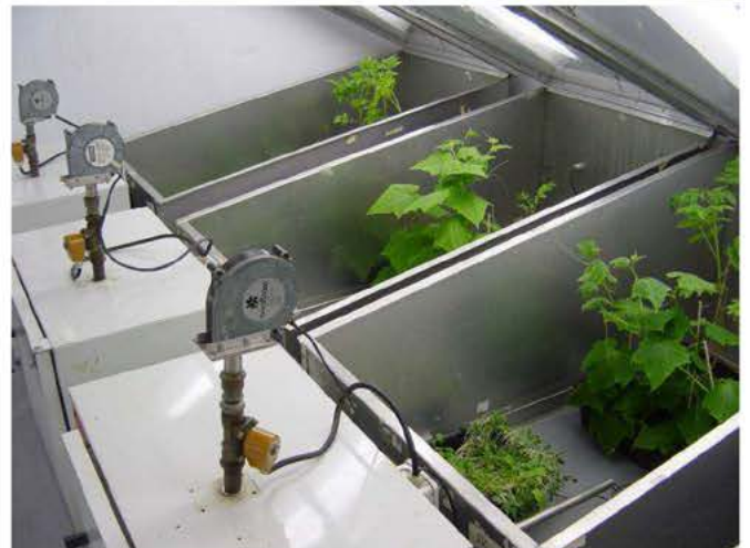
Fig. 2: Sopra: danni da vapori causati da tubi di riscaldamento flessibili su piante di cavolo cinese e cetriolo. Sotto: Strutture di prova.
