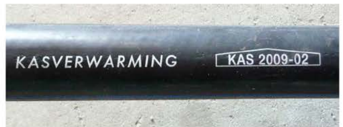
Fig. 3: Code d'approbation sur un tuyau de chauffage de serre
