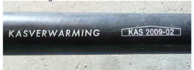
Abb. 3: Prüfcode auf einem Gewächshausheizungsrohr
